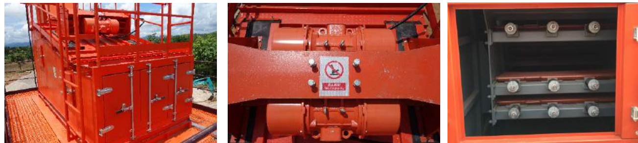
意大利OLI品牌/ 双电机直线型/ 高耐磨筛网 Italy OLI brand / Double vibrator linear type/ High wear resistance mesh screen
