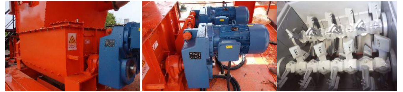
意大利MARINI技术/ 电机直连/ 铬钼锰合金钢耐磨材料 Italy MARINI design / Direct connection / Chromium manganese alloy steel
