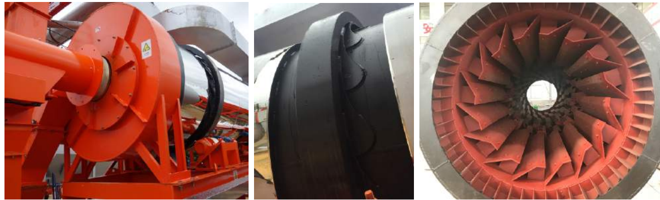
美国ASTEC设计弹性板/ 内部刮板采用日本Nikko设计/ 电机硬齿面直连 USA ASTEC Design Elastic Plate/ Inner blades adopt Japan Nikko Design/ Motor direct connection
